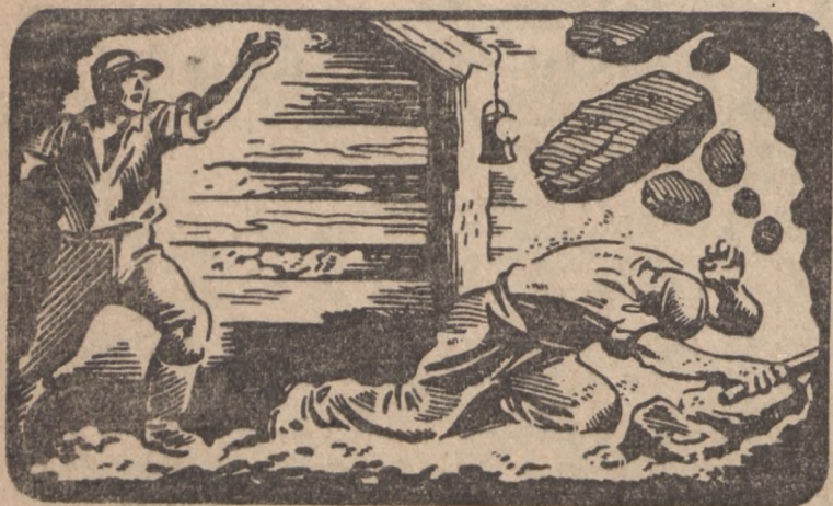
A be nem ácsolt munkahely beomlik, sérülést okoz. Az oktatáson felhívják figyelmet a munkahely biztonságára és mégis elhanyagolt!
