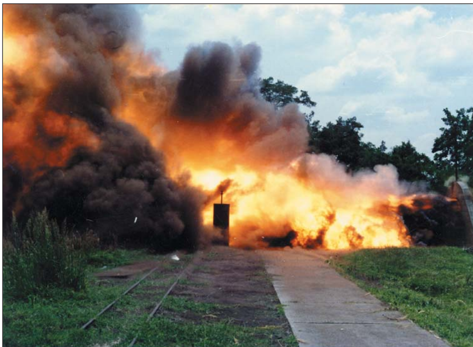
A kísérleti robbantótárból kicsapódó láng-, por-, füst-, és gázfelhő mesterségesen létesített szénporrobbanásnál
