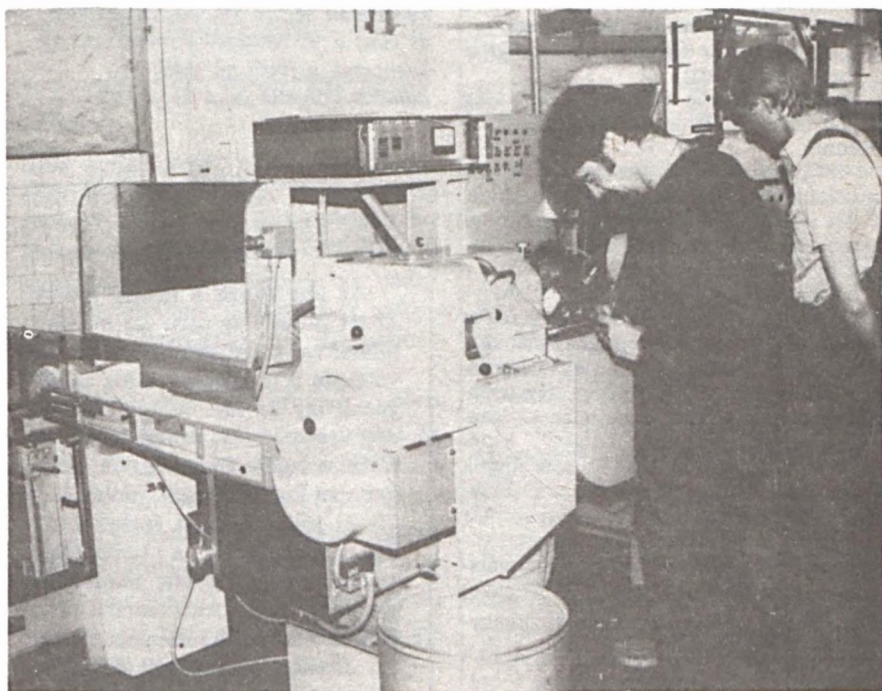
Korszerű gépeink közé tartozik az a MOLINS is, amelyet a kamrás filterrúdgyártásban használunk, s amelynek beüzemelése a közelmúltban volt.
