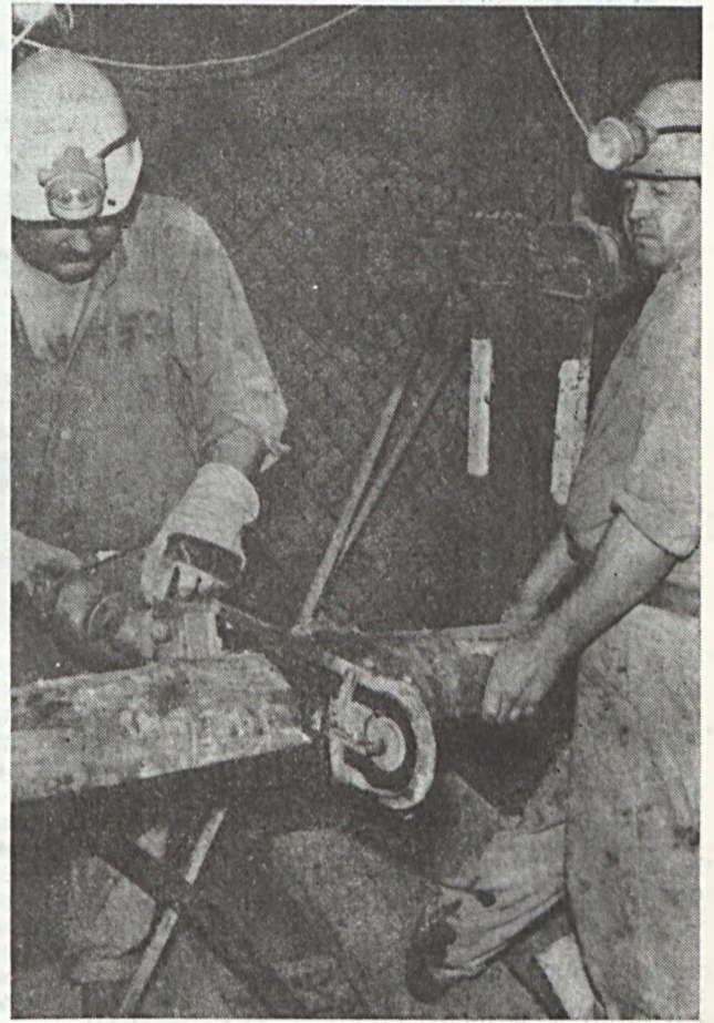
Torma Attila csapatvezető (balról) és Dávid András segédvájár munkáját a sűrítettlevegős fűrészgép is segíti. Csöndör László felvétele
