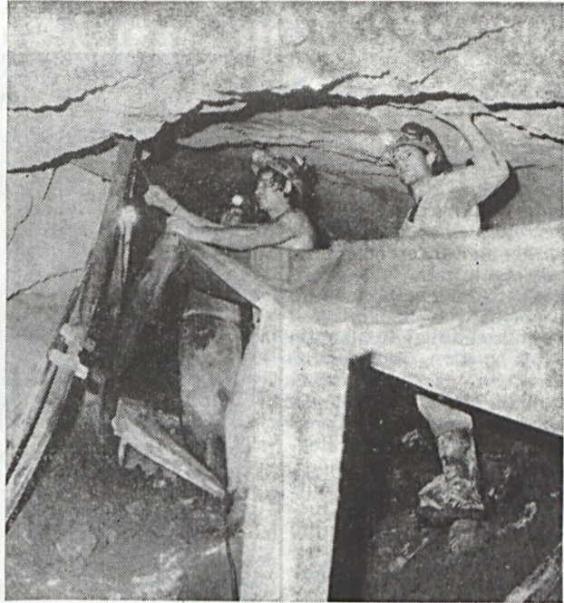
A képen balról jobbra, Nagy Tibor vajúv, Pércsi Zoltán csapatvezető vajúv és Váradi Artúr vajúv a műanyag légesatorna szerelése közben. Bálint Jenő felvétele
