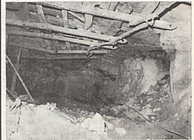
A baleseti helyzet javítását szolgáló műszaki újdonság a II. sz. bányában az SVG fémsüveg vasfeszékkel történő alkalmazása fejtekben
