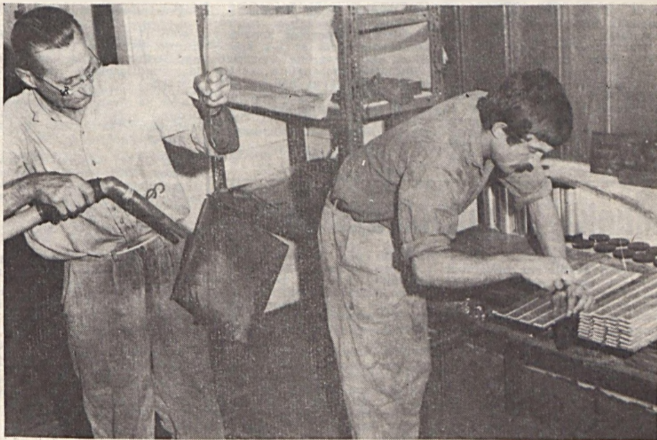
A Kísérleti kutatási és automatizálási üzem galvanizáló műhelyében Alpár Jenő passzivált kadmiummal felülkezelte lemezt szárít levegővel (balról), Takács Jenő alumínium műszeralkatrészeket „szerszámoz” fel eloxáláshoz Keller Gábor felvétele
