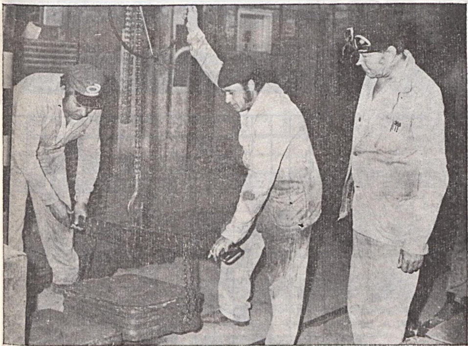
Vállalatunk beruházási osztályának megrendelésére a Szolgáltató üzem öntődjében Forramat 20-as típusú, NDK gyártmányú gépen leformázott csilleütközőbak mintáját rendező Mátyás Nándor és Garai Ede formázó. Képünkön jobbról Kruppa Antal művezető.
