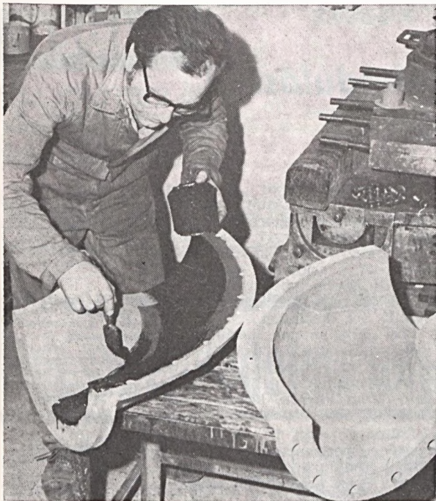
Jelenik István a nagy kopásálló lágygumis ívek gumiragasztását végzi. Keller Gábor felvétele
