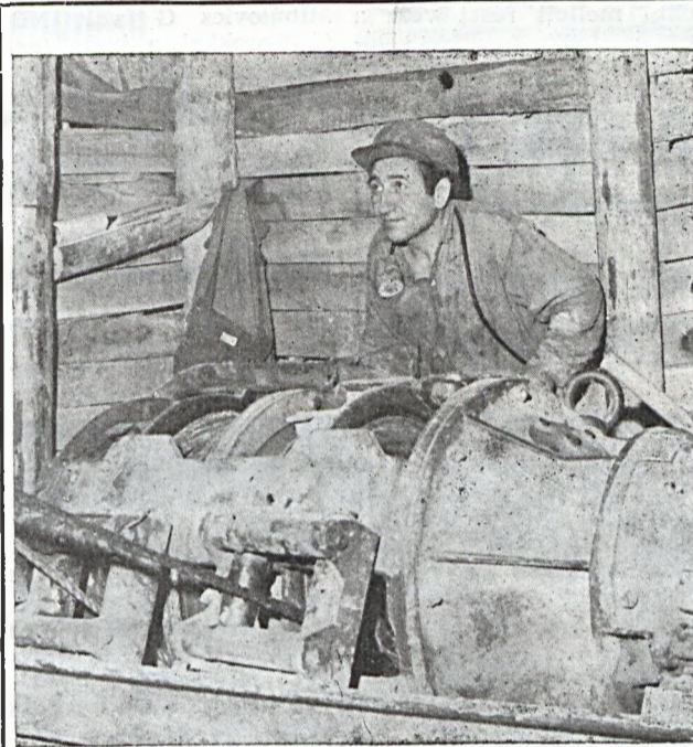
Oláh János csapatvezető vájár és ifjúsági szocialista brigádvezető saraboló vitlával készletszállítást végez a IV. sz. bányauzem 6-os csapatánál.
