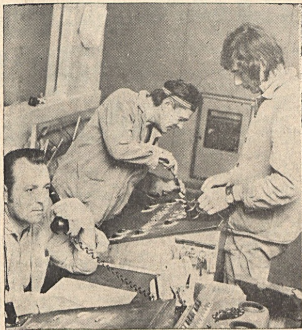
Előtérben Háló Péter, az EDÜ diszpécser telefonon intézkedik, hátul Pálfi György és Hoffer János a golyósmalom hajtásszabályozó automatikáján karbantartási munkákat végez.
