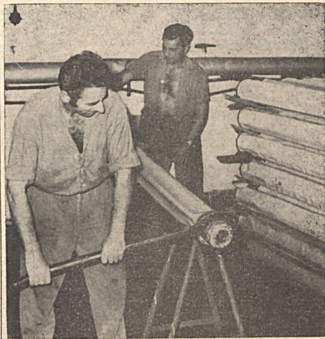
Az ÉDÜ aranyéremre pályázó Komarov szocialista brigád két tagja, Pongrácz Sándor és Pászti Gábor, a végtermék üzemrész szűrőjéhez vászon borítású oszlopokat szerel. Keller Gábor felvétele
