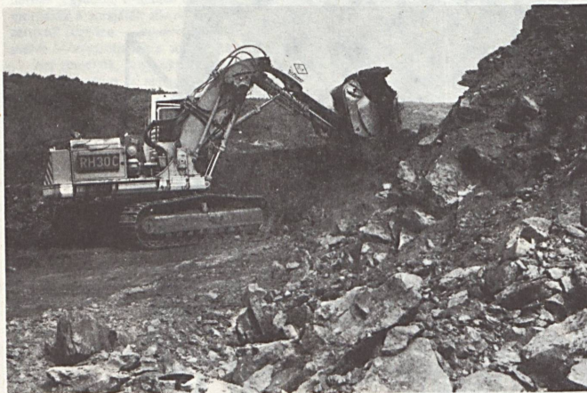
A külfejtési üzem pécsbányai területén a keleti nyíláson dolgozik a kotrógép (képünkön). Ez a térség, közvetlenül a pécsbányatelepi kertek szomszédságában, az eredeti terepszinttől mintegy 100 méter mélységig kerül művelésre. Az üzem vezetői ennek a fejtési térségnek meghatározó szerepet szánnak az éves széntermelési feladat teljesítésében
