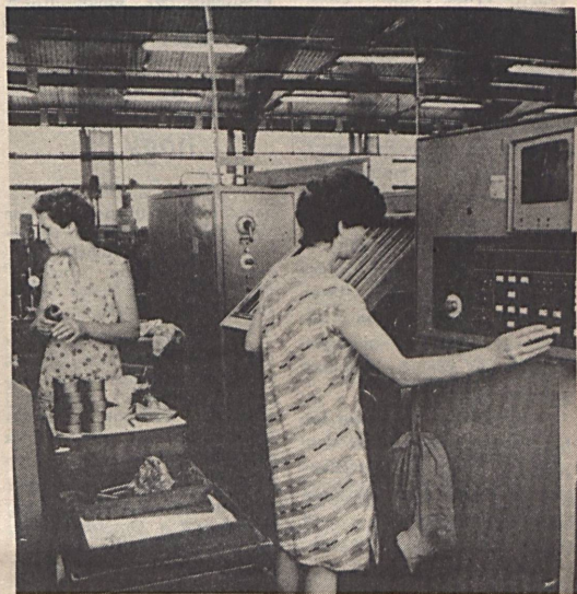
A MOM komlói gyárának alkatrészüzemében CNC esztergagépeken munkálják meg a fékberendezések alkatrészeit. Tóth László felvételei
