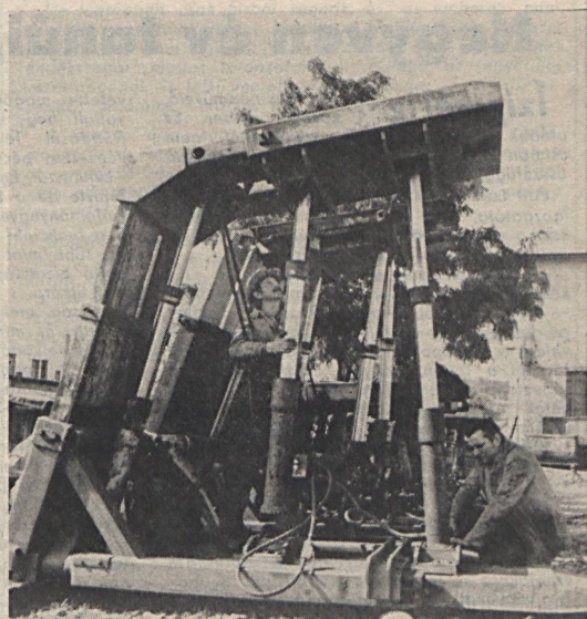
Béta-bánya udvarán szerelik a november 1-én beépítésre kerülő MASCS-berendezést. Körödi G. felvétele
