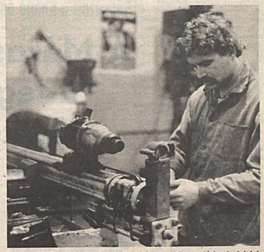
Baranyai László és társainak újítása a képen látható fejtési hosszúlyukas injektáló fúrásokhoz fúrógéptartó és előtöltő berendezés. A gép sürített levegővel működik, a segítségével a fizikai munkát nagymértékben lehet csökkenteni.
