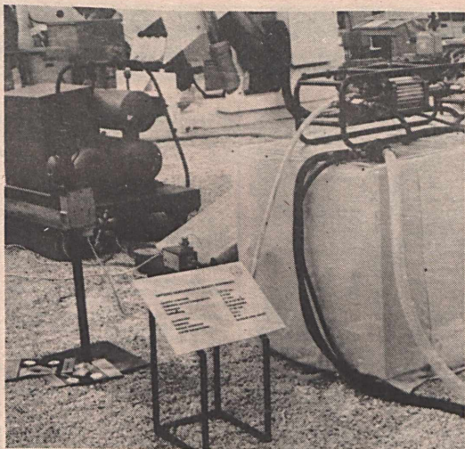
Képkönyvön a keményhab-keverő szivattyú a Mecseki Szénbányák kiállítási standján.
