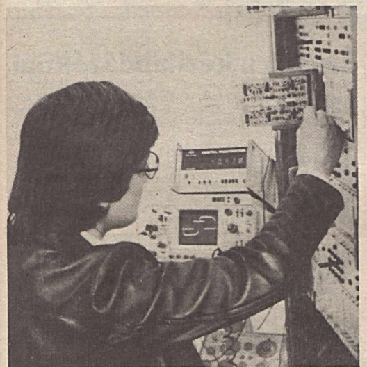
Sebestyén Tibor, a VBKM TRANSZVILL gyárának mérnöke a szállító-gép vezérlőegységét méri és állítja be
