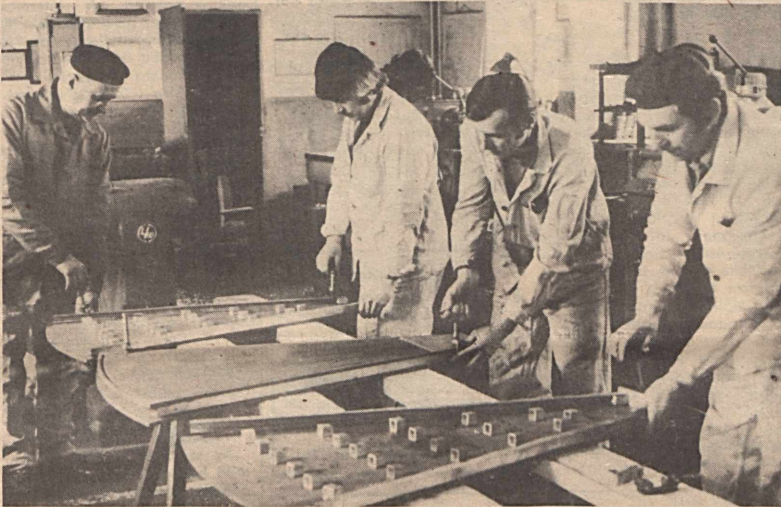
A pécsi Szénelőkészítő Üzem gépészetének Buzsáki Imre 16 fős, többszörös aranykoszorús és a vállalat kiváló brigádja vállalta, hogy 1981-ben társadalmi munkában szereli össze a vizenitő üzem részére szükséges tárcsaszűrő szegmenseket. Ezenként 100 db beépítésére van szüksége az üzemnek a tmk-terv alapján, 9 brigád a társadalmi munkáját a minőségi követelményeknek megfelelően és balesetmentesen végzi. A 100 db tárcsaszűrő szegmens szerelésére 400 óra társadalmi munkaóraát vállaltak. Fotó: Kóródi Gábor
