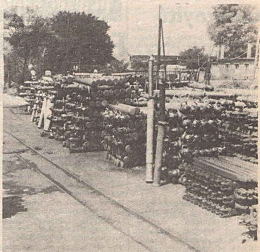
3000 fémtám vár javításra a Központi Gépüzem udvarán. Közülük sok már csak az olvasztóban „használatos”. Fotó: Beck P.
