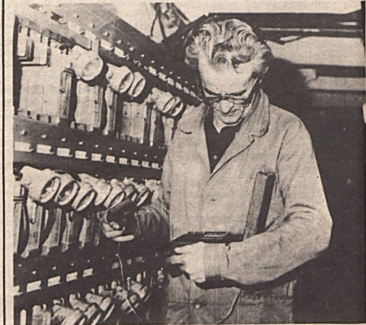
Nagy Béla, a Béke szocialista brigád vezetője műszerrel vizsgálja a lámpák üzemképességét
