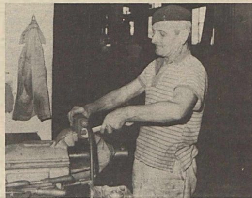
Tóth László, aki szintén a Zalka Máté brigád tagja, az airbrecker lövszelepet javítja.
