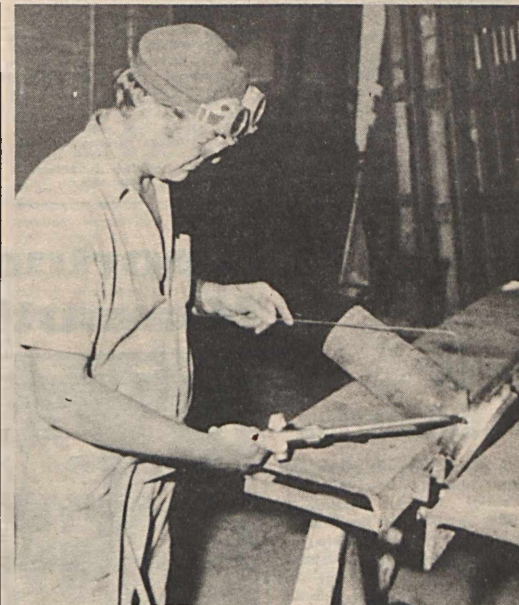
Fábián Ottó, a mézesréti üzemi vízmű rekonstrukciós munkáihoz hegesztő az alkatrészeket.
