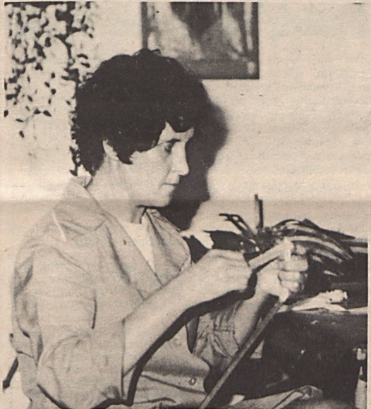
Tatár Lajosné AF típusú villanymotorhoz készülő forgórész pálcákat szigetel. Maletics László felv.
