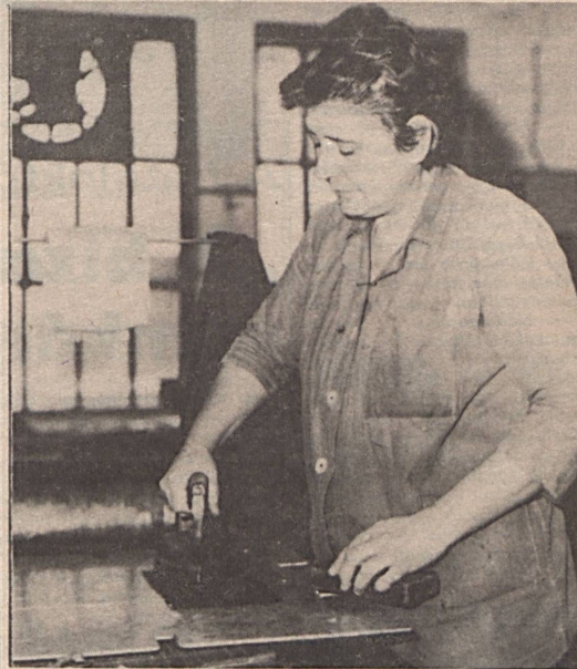
Az AF típusú villanymotorokhoz készülő „Mika” szigetelők összevasalását végzi Nimsz Antalné a Vilamos Üzemben.
