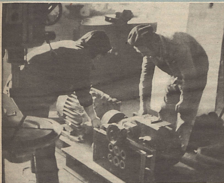
A brigád tagjai a távolságtartó recéző berendezés szerelését végzik
